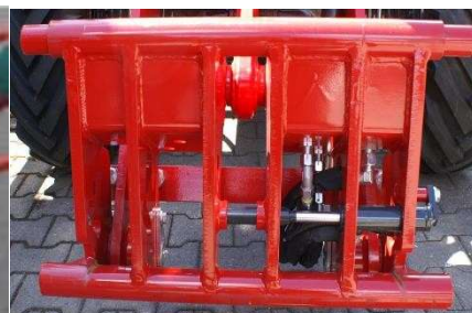
Uusi taler-kiinnike Laitteet, jotka on valmistettu vanhalle Thaler-kiinnikkeelle, sopivat myös tähän kiinnikkeeseen.
